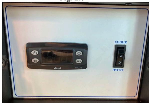
Der Regler ist für Gefrier und Kühl programmiert bei Hilfe eines Schalter, der zwischen diese 2 Funktionen wechseln können.
